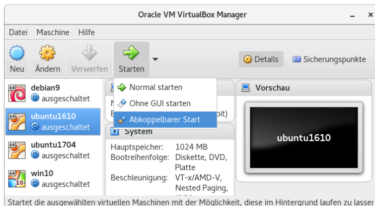
Abbildung 39.5 Das Menü des Start-Buttons enthält zwei versteckte Einträge zum Start der virtuellen Maschine ohne bzw. mit abkoppelbarer Oberfläche.
